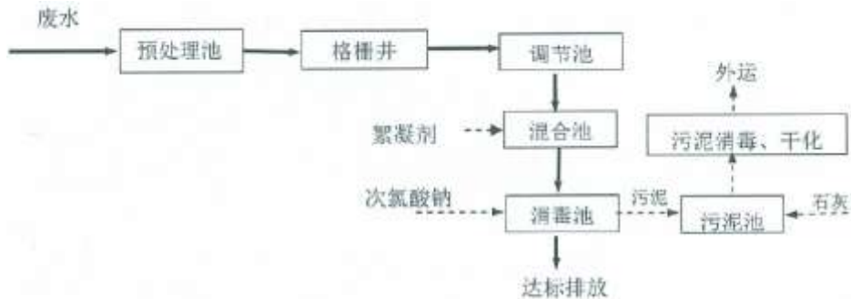
图 3.3-2 现有项目污水处理站工艺流程图
